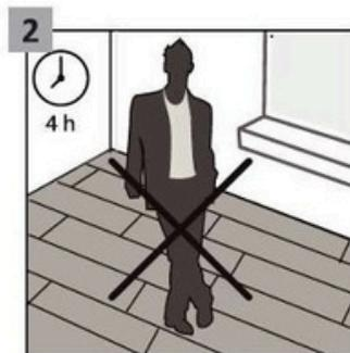
Pokud jsou panely instalovány pomocí lepidla, lze na podlahu pokládat těžké předměty až 72 hodin po nalepení, po 4 hodinách po nalepení lze po podlaze opatrně chodit.
