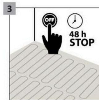
48 hodin před vypnutím podlahového vytápění a je nutné upravit teplotu podlahy na 18-20 °C nebo použít alternativní zdroj vytápění, aby byly dodrženy pokyny pro teplotu a vlhkost podkladu.
