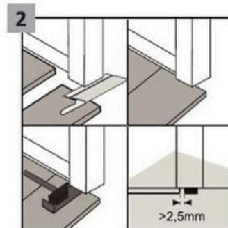
U dveří se doporučuje podřezat profily zárubní a ponechat volný prostor nad instalovaným panelem, aby nebyl omezen jeho možný pohyb.
