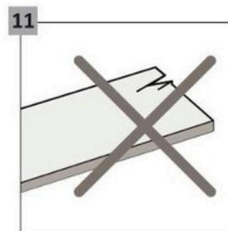
Všechny panely by měly být zkontrolovány před instalací a během ní za optimálních světelných podmínek. Neinstalujte vadné panely.
