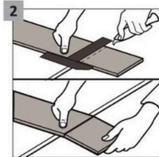
Při dodatečném řezání podlahových panelů odřízněte horní vrstvu ostrým nožem a rychle odlomte část panelu položenou přes okraj. Kromě toho lze podlahové panely snadno řezat elektrickou pilou.
