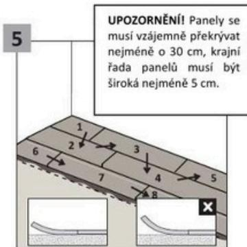
Desky přilepte k podkladu tak, aby byly těsně u sebe a nezůstávaly mezi nimi mezery. Dodržení rovnoměrných rozestupů prvních dvou řad panelů ovlivní vizuální výsledek pokládky celé místnosti. Panely by se během instalace neměly ohýbat.
