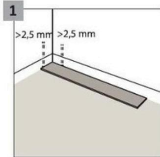
U stěn ponechte spáru minimálně 2,5 mm, abyste umožnili dilataci podlahy. Maximální plocha, kterou lze položit bez dodatečných dilatačních spár, je 200 m<sup>2</sup>. Nad touto plochou vytvořte dodatečnou dilatační spáru a všechny dilatační spáry zvětšete na 5 mm. Maximální délka podlahové plochy v jednom směru, kterou lze položit bez dodatečné dilatace, je 20 m. Nad tuto délku vytvořte dodatečnou dilatační spáru a všechny dilatační spáry zvětšete na 5 mm.
