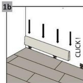
Dilatační spáry podél stěn musí být zakryty ozdobnou lištou, která se instaluje pomocí lepidla nebo speciálních spon
