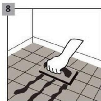
V případě pokládky na keramické dlaždice je třeba spáry dlaždic vyplnit odolnou spárovací hmotou. Kromě toho je třeba použít samonivelační stěrku, aby se dosáhlo hladkého povrchu s rovnoměrnou savostí.
