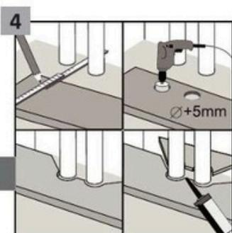
Podobně postupujte i v případě většího počtu trubek v topném systému. Prvky vyříznuté z panelů musí být spojeny montážním lepidlem na plasty. Těžko přístupná místa je třeba dodatečně přitlačit malým válečkem.
