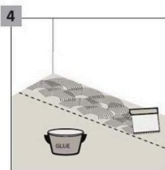
Používejte pouze lepidla doporučená výrobcem podlahy. Panely musí být instalovány na mokré lože - po nanesení lepidla na podklad by měly být panely okamžitě položeny a zavalčovány. Upozorňujeme, že přebytečné lepidlo může vytékat mezi spoji panelů a být viditelné na povrchu podlahy a mělo by být odstraněno vlhkým hadrem.
