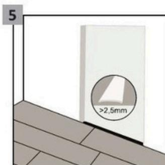
Napojení na přilehlé podlahové krytiny by mělo být opatřeno ozdobnými profily s ponecháním dilatačních spár stanovených výrobcem.
