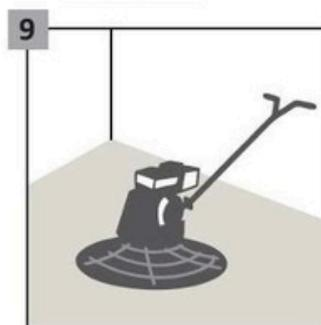
Pokud je použita samonivelační stěrka, je třeba povrch obrousit, aby se vyrovnal a odstranila se vrchní vrstva kalu.
