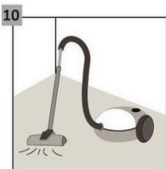
Těsně před instalací je třeba podklad důkladně vysát, aby se odstranily všechny nečistoty.
