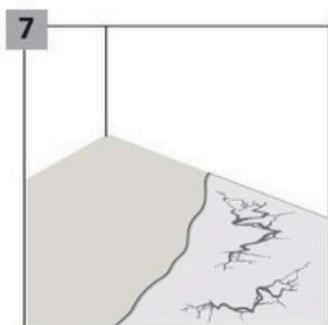
Typ podkladu, jeho kvalita a příprava, zejména nerovnosti, mají rozhodující vliv na výsledný efekt, proto je nutné podklad vyrovnat samonivelační stěrkou. V případě keramických obkladů a dlažeb nebo dřevěných podkladů (OSB desky, překližka) připravte podklad podle doporučení výrobce doporučeného lepidla.
