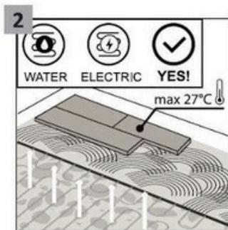
Podlahové panely lze použít na podkladech se zabudovaným podlahovým vytápěním (vodním nebo elektrickým), pokud je během provozu udržována maximální teplota povrchu podlahy 27 °C.
