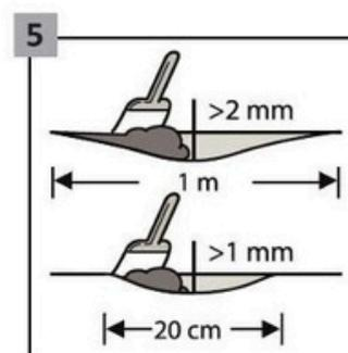
Ujistěte se, že je podklad rovný. Jakékoli nerovnosti povrchu přesahující 1 mm na délce 20 cm nebo 2 mm na délce 1 m je třeba vyrovnat.
