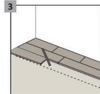
Nakreslete čáru tak, abyste pokryli část podkladu lepidlem o šířce tří řádků a maximální ploše 7 m pro lepení panelů. Pro dosažení nejlepších výsledků můžete začít instalaci od středu místnosti a pokračovat v pokládce ve dvou směrech.
