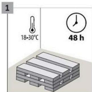
Doba aklimatizace musí trvat minimálně 48 hodin v místnosti, kde budou panely instalovány. Teplota v místnosti pro aklimatizaci musí být 18-30 °C. Pro usnadnění procesu aklimatizace umístěte maximálně 3 obaly na jednu vrstvu.
