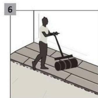
Okamžitě po položení tří řad desek je přesně a rovnoměrně přitlačte k podkladu pomocí 50kg válečku. Příliš pozdní válcování nebo nesprávné přitlačení na těžko přístupná místa může mít za následek nedostatečnou přilnavost panelů. Doporučujeme položenou podlahu po každých 50 m<sup>2</sup> znovu převálcovat. POZOR! Při použití silanových a polyuretanových lepidel - pokud se panely začnou během válcování rozpadat nebo lepidlo prosakuje spárami, počkejte 15-30 minut a válcování opakujte.
