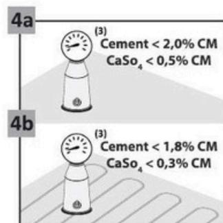
V případě cementového potěru musí být vlhkost podkladu před litím vyrovnávací hmoty nižší než 2,0 % a v případě anhydritového potěru nižší než 0,5 %. V případě instalace s podlahovým vytápěním musí být výše uvedené hodnoty 1,8 %, resp. 0,3 %.
