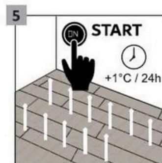
Podlahové vytápění zapněte až 48 hodin po položení podlahy v režimu postupného zvyšování teploty vzduchu v místnosti o 1 °C denně. POZOR! Maximální přípustná teplota povrchu podlahy je 27 °C.
